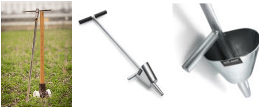
Abbildung 2: Schlagbohrer; Schüsserlbohrer zur Beprobung von Grünlandflächen
